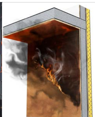
Berliner Brand: Hartfaserplatten innen und außen als verlorene Schalung. Auf deren gefährliche Rolle wurde in den ersten Zeitungsberichten noch hingewiesen, 4 Jahre später jedoch das WDVS zum Problem erklärt.
